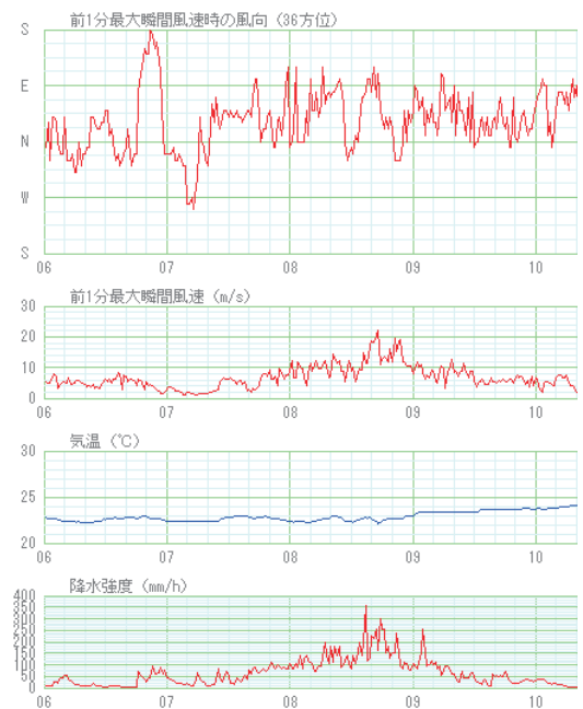
第 7 図 奄美南部豪雨におけるアメダス古仁屋の 1 分毎風・気温・降水強度の時系列（2011 年 11 月 2 日 6 時～10 時 20 分）
